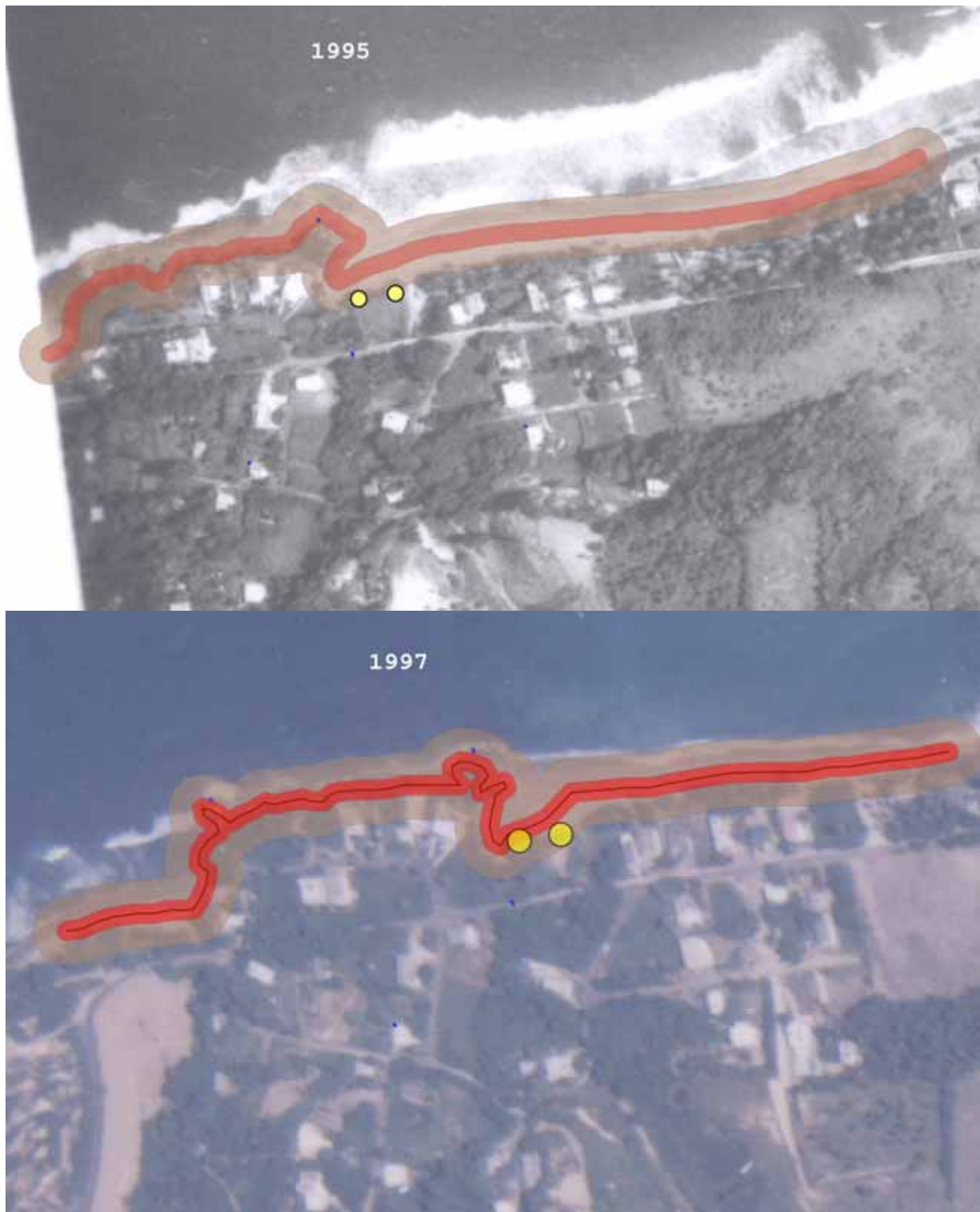
Figura 3 e,f: La línea fina, y sólida, muestra la frontera entre arena seca y arena mojada. La franja roja muestra la Servidumbre de Vigilancia (6 metros) y la franja más ancha muestra la Servidumbre de Salvamento (20 metros). Los círculos amarillos muestran las dos esquinas del edificio según foto del 2006.
